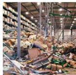
Gli eventi sismici del recente passato registrati in Italia e in altri paesi a sismicità media o elevata hanno contribuito ad evidenziare la vulnerabilità delle strutture ma anche degli elementi non strutturali per lungo tempo non considerati nella progettazione del nuovo o nella valutazione dell'esi-
