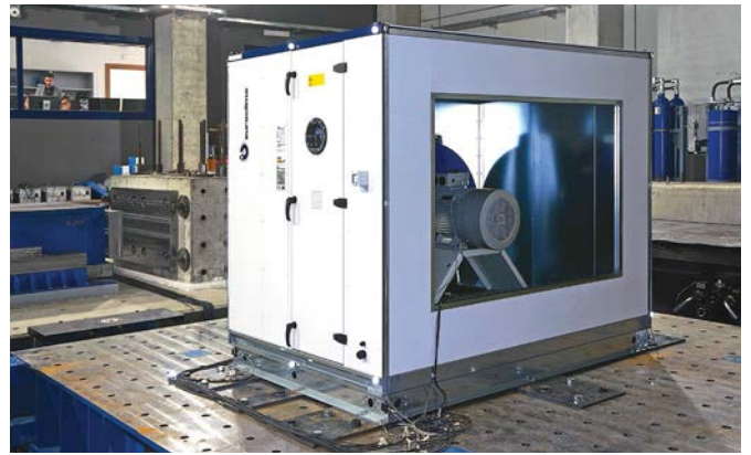
Prove su unità trattamento aria
