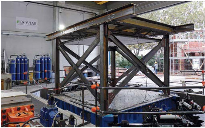
Prove su controsoffitti
