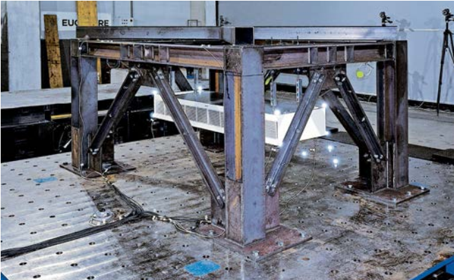
Prove su ventilconvettori sospesi
